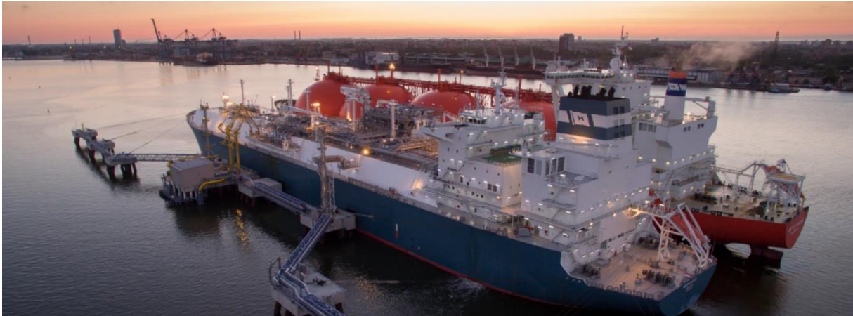
Abbildung 27: Typische FSRU (170.000 m 3 ) und Entladung eines LNG Tankschiffs
